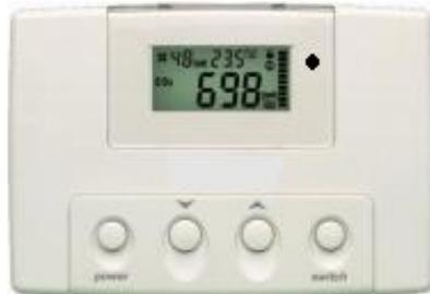
**| Equipo con sondas integradas para la lectura ambiental de dióxido de carbono (CO2), temperatura y humedad relativa. Dispone de 3 salidas independientes digitales (2A) asociadas a los 3 setpoint seleccionables, para el control de distintos equipos asociados a cada una de las 3 lecturas.**
