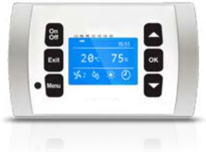
La ventilación tiene tres velocidades y se gestiona automáticamente en función de las activas. Presenta tarjeta reloj con franjas horarias: 7 programas diarios, 24 franjas horarias por día, parámetros configurables: unidad on/off, humedad y temperatura.
